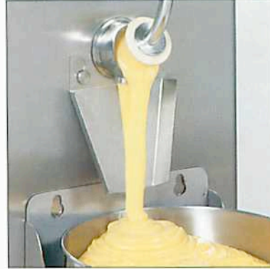
SICHERHEITS-AUSGABEBEHN mit einer Position für die Ausgabe der flüssigen Produkte und einer für die dickflüssigen Produkte.
